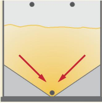
**Passiv:** Pellets rutschen zur Entnahmestelle und werden mechanisch beansprucht.
