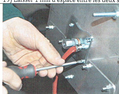
21) Visser le support allumeur au corps du bruleur. L'espace cité au point 19 assurera l'étanchéité correcte su cône sur le trou à l'intérieur et évitera le passage de l'air et donc possibles problèmes d'allumage
